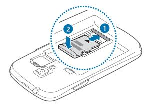
3 Drücken Sie die Speicherkarte nach unten in den Karteneinschub und schieben Sie die Karte nach hinten, bis sie einrastet.
